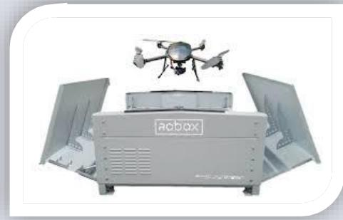
**14. Dron in a Box.** Es una innovadora solución tecnológica que permite a los drones operar de forma automática y autónoma, integrándose en un sistema que incluye una estación de base para almacenamiento, carga y gestión. Estos sistemas revolucionan la gestión de drones, facilitando operaciones remotas, automatizando inspecciones y permitiendo la gestión de múltiples drones desde un mismo punto.
