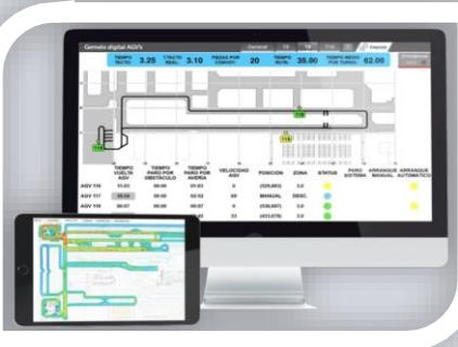
**37. Gemelo Digital.** Modelos virtuales que recrean con exactitud un objeto físico, proceso o sistema. Se utilizan para realizar simulaciones y estudiar el comportamiento de un producto digital. Después permite adaptar las soluciones al producto real de una manera eficiente.
