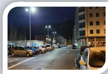
**45. Farola conectada.** Plataforma que permite la gestión de forma remota del encendido y apagado de cada farola de un determinado espacio. Permite modificar los niveles de intensidad lumínica y adaptar los niveles de alumbrado de cada zona. También, el sistema está preparado para detectar posibles fallos del alumbrado (antes de que éstos se produzcan y afecten al ciudadano).
