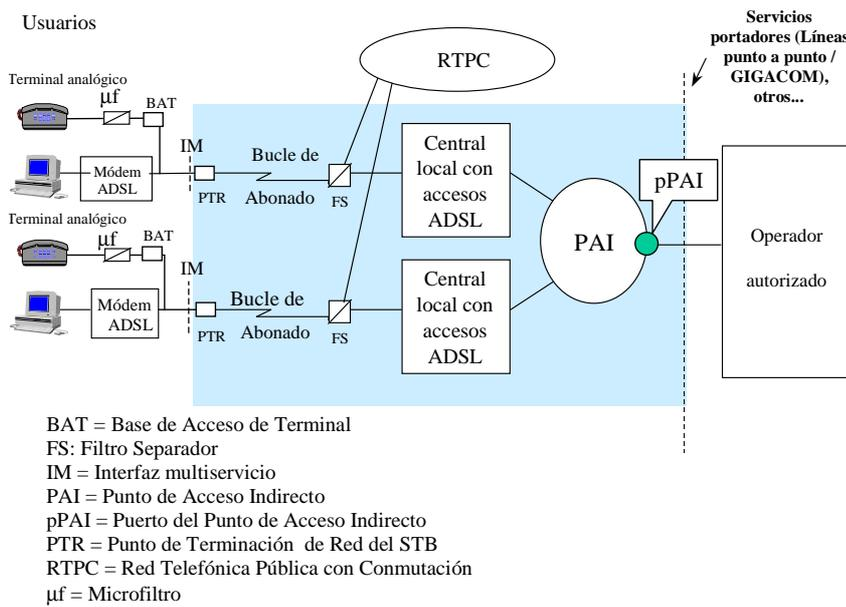
Figura 1: Arquitectura de Red para el Acceso Indirecto al Bucle de Abonado con filtrado distribuido
